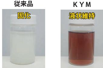
条件:原液に紫外線硬化型塗料20%を添加後、蛍光灯下で30日間放置
